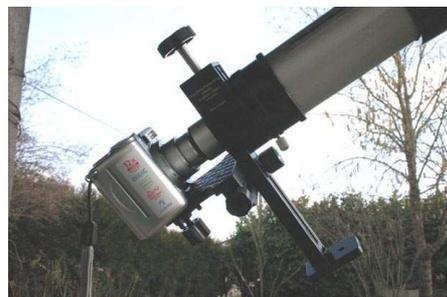
Fig.6. Installation de l'APN sur la lunette avec un oculaire de 20 mm.
